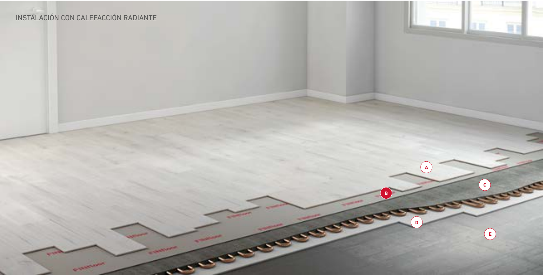
A FINFLOOR B MANTA SILENT ELITE FINFLOOR C CALEFACCIÓN RADIANTE D AISLANTE E SOLERA
